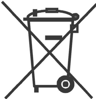
Das Symbol muss mindestens 3% der größten Seitenfläche der Batterie, des Akkumulators oder des Batteriesatzes, höchstens jedoch eine Fläche von 5 × 5 cm, einnehmen. Bei zylindrischen Formaten muss das Symbol mindestens 1,5% der Oberfläche der Batterie oder des Akkumulators, höchstens jedoch eine Fläche von 5 × 5 cm, einnehmen.
